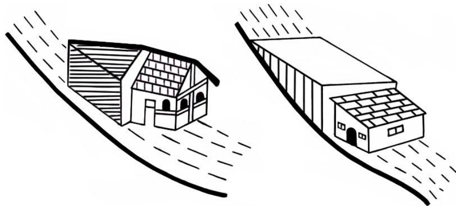
ნახ. 26. შესაბამისი კონსტრუქციებით საცხოვრებელი სახლების დაცვა ზვავებისაგან.
