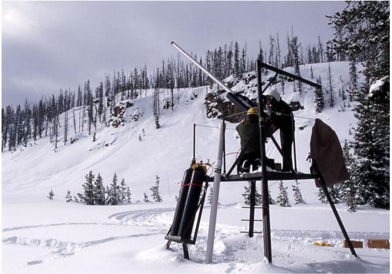
ნახ 35. პნევმატური ქვემეხი AVALAUNCHE.
