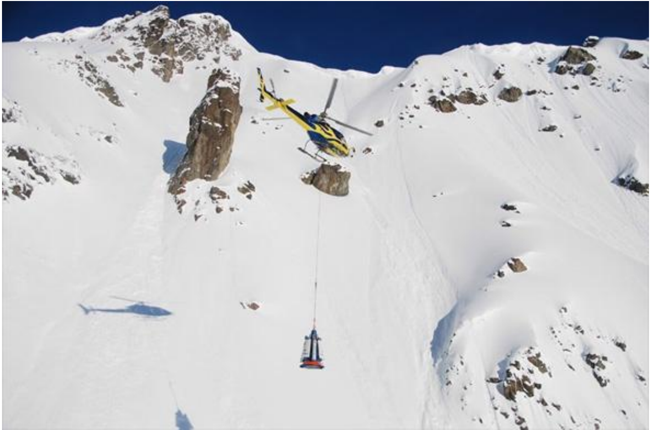
ნახ 36. DAISYBELL-ით (ე.წ.“ზარიტ”) ზვავშემკრებზე ზემოქმედება.
